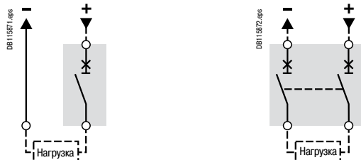
Выбор 1: стационарный 1-полюсный аппарат Compact NSX160N DC
