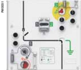
Механизм C1T в ячейке IO6T
