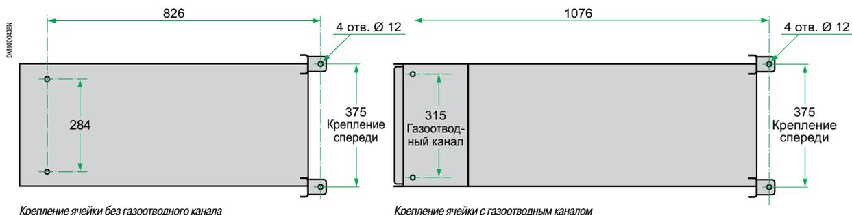
Крепление ячейки без газоотводного канала
